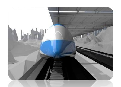
高速飞行列车:利用磁悬浮消除摩 擦阻力,利用近真空减小空气阻力, 利用直线电机提供牵引力,实现 "贴地飞行"。
